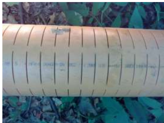
Rakovec 2014 – vytažené potrubí původního drénu a část potrubí nového drénu
