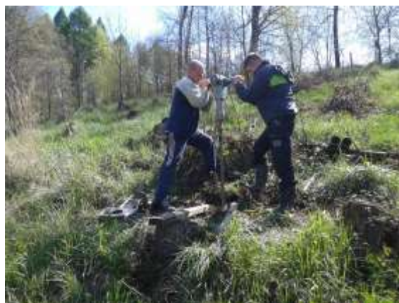
Vrtání sond pro sledování pohybu svahu
