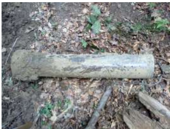
Rakovec 2014 – vytažené potrubí původního drénu a část potrubí nového drénu
